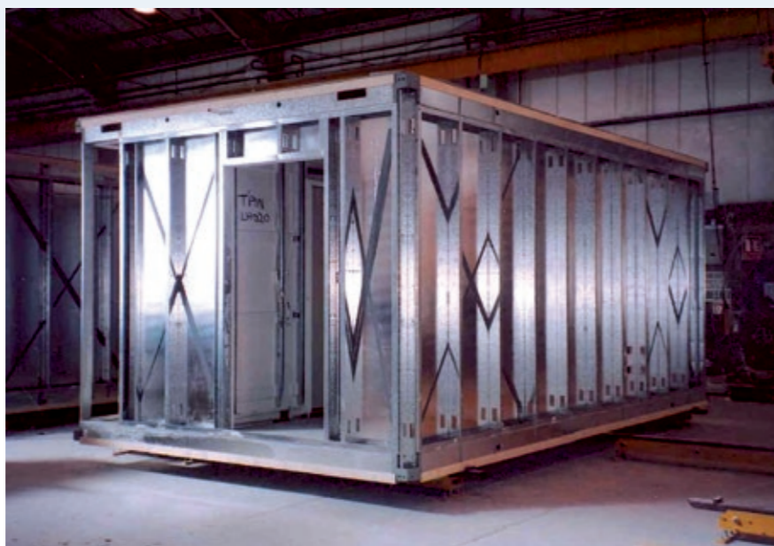
Рисунок 6.2 Типовой несущий модульный блок здания Terrapin
