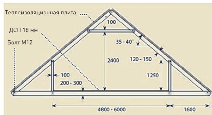
Рисунок 7.7 Система «открытой крыши» с каркасом из тонкостенных стальных профилей
