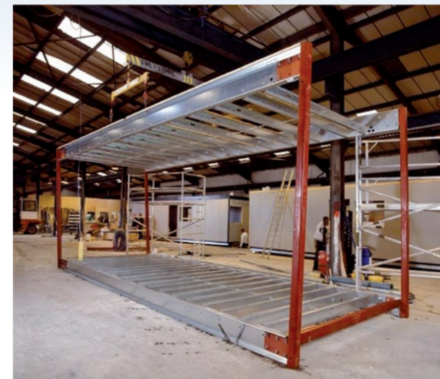
Рисунок 6.3 Модуль с несущими балками и угловыми стойками Kingspan
